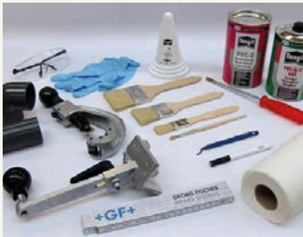
1. Udstyr: Rørskærer, affasningsværktøj, pensel, tomrestok, pen, fnugfri papir og Tangit rensesvæske og klæber.
